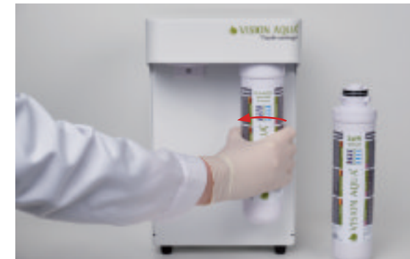
Drehen Sie den Aktivkohle-Nachfilter um 90° gegen den Uhrzeigersinn aus dem Filterkopf der VA-Mini.
