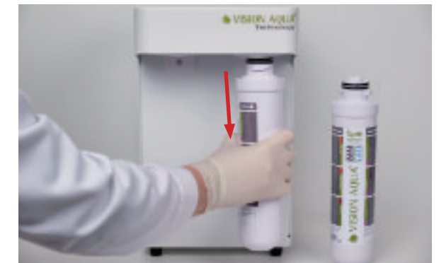
Nun können Sie die Filterkartusche aus dem Filterkopf herausnehmen.
