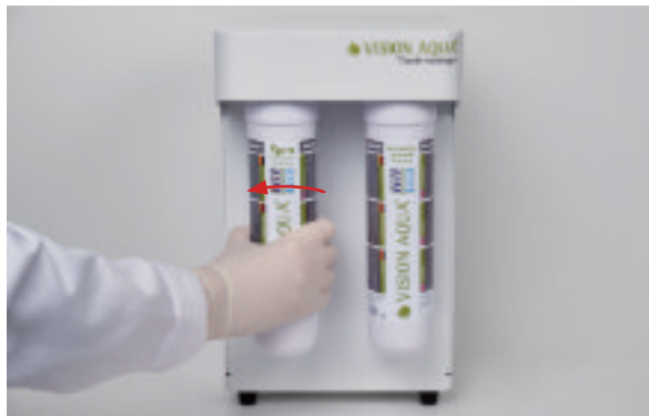
Drehen Sie die PP Filtereinheit um 90° gegen den Uhrzeigersinn aus dem Filterkopf der VA-Mini.
