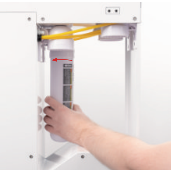
Drehen Sie die zweite Filterkartusche gegen den Uhrzeigersinn um 90° aus den Filterkopf heraus um die zweite Filtereinheit zu wechseln.
