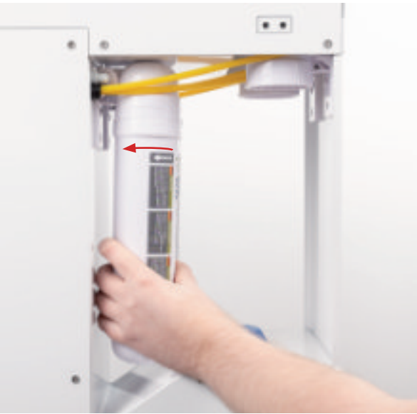
Die Nachfiltereinheiten wechseln Sie wie die Vorfilter. Drehen Sie Filterkartuschen gegen den Uhrzeigersinn um 90° aus den Filterkopf heraus um die Filtereinheit zu wechseln.
