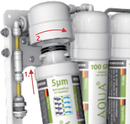
Setzen Sie die neuen Filtereinheiten in die Filterköpfe ein und drehen Sie dabei die Filterkartuschen um 90° im Uhrzeigersinn. Die Filtereinheiten müssen anschließend in den Befestigungsschellen einrasten.
