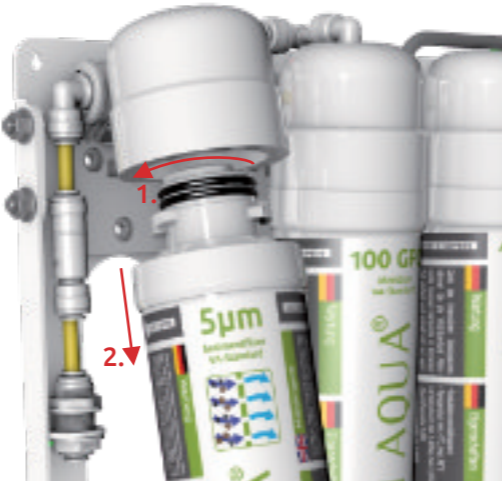
Drehen Sie Filterkartuschen gegen den Uhrzeigersinn um 90° aus den Filterköpfen heraus um die Filtereinheiten zu wechseln.
